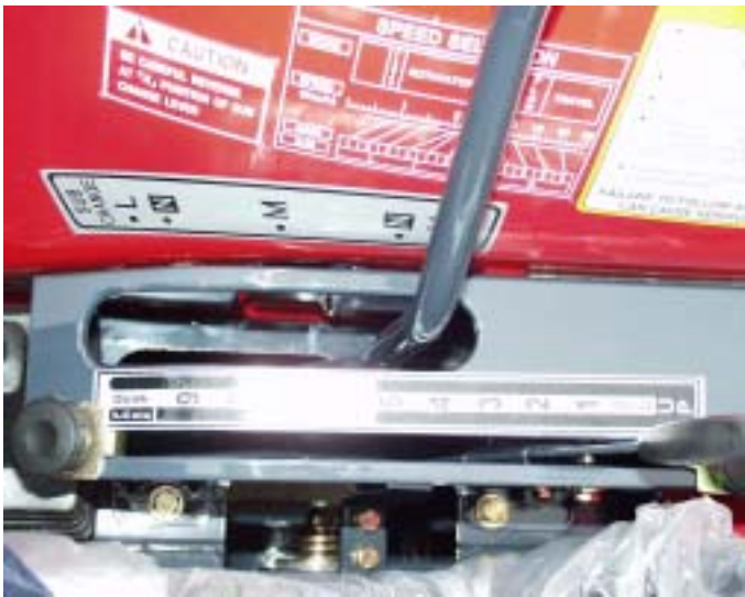
FIG.2-26 Range shift lever
